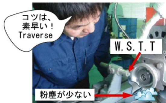
写真3 レアメタル(WSTT)を使ってドレッシングとツルーイングを同時に行う
